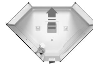
10.2 С помощью саморезов 4\*12 43 прикрепите крышу к каркасу задних стенок душевой кабины.
